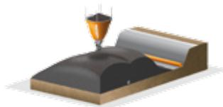
ecoglas® ca. 30 % überhöht einbringen und verteilen (Verdichtungsfaktor 1 : 1,3)
