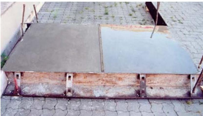
Bild 1: Versuchsplatte, links unbehandelt, rechts mit AF behandelt
