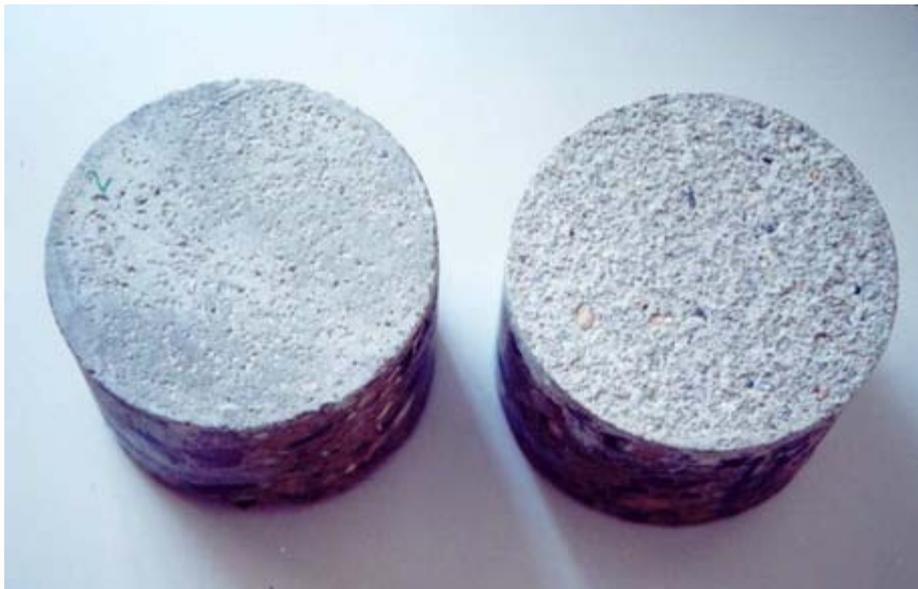
Bild 2: Betonflächen nach der Frost-Tausalz-Beaufschlagung
